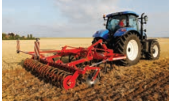
▲ Die Terrano is 'n swaardiens beitelploeg met 'n werkswydte van 3 m tot 6 m en 'n werksdiepte van tot 35 cm.
