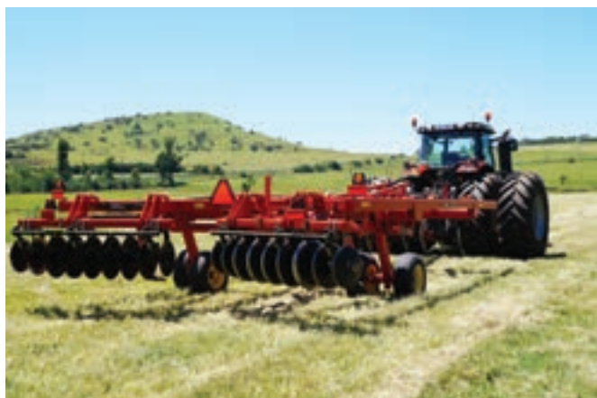
▲ Die Sunflower kombinasie-skottelskeurploeg het 'n ry skottels voor en skeurploegtande agter om 'n dieper algehele bewerking te gee en plantmateriaal dieper met die grond te vermeng.
