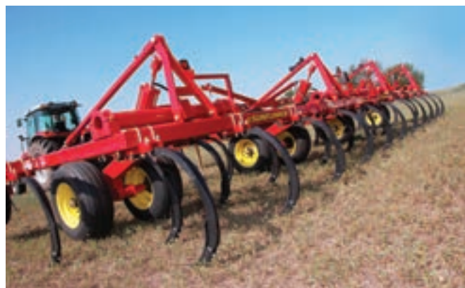
▲ Sunflower se duursame beitelploë is beskikbaar met 25 tot 41 tande en benodig 6 kW - 10 kW per tand.
